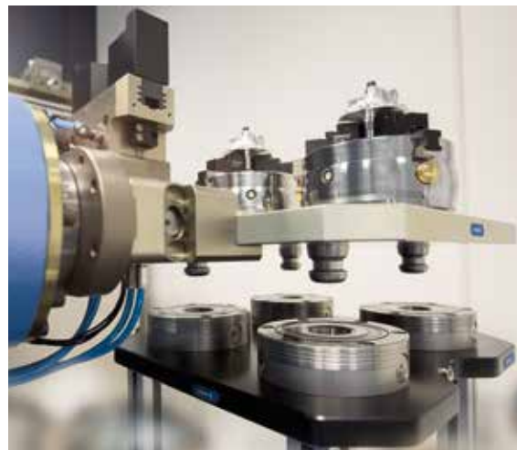
Die Spannmittel und Greifsysteme von SCHUNK gewährleisten bei der Beladung von Werkzeugmaschinen eine maximale Effizienz und Prozesssicherheit.
