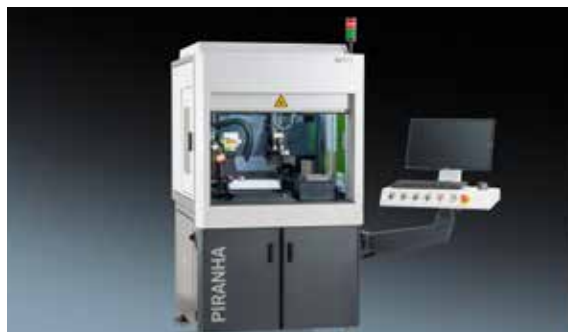
Die Laseranlage mit Robotikgreifer, Lageerkennung und automatischer Abarbeitung.
